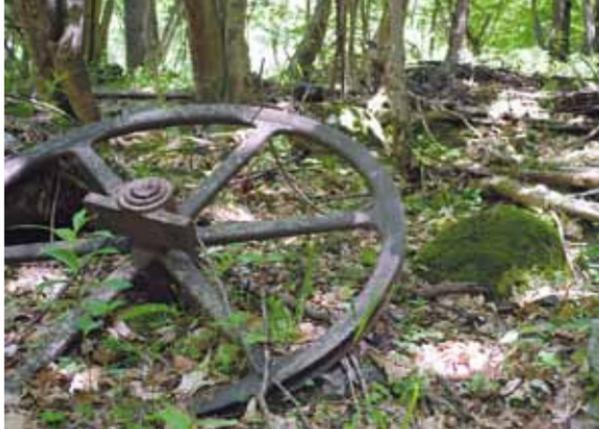
*Questa ruota appartiene al castello della stazione di partenza della teleferica Valtellina. Il castello era composto di due ruote disposte orizzontalmente (volanti) a cui era applicato il freno dell'impianto.*
